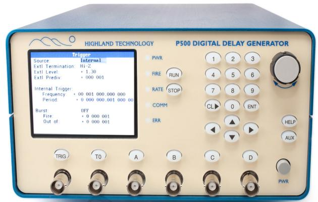
P500 是一款台式数字延迟和脉冲发生器，可生成四个独立的可编程延迟和宽度输出。P500 可以以 1 皮秒的增量产生长达 1000 秒的延迟，并且能够实现 14 MHz 的高重复率。P500 的应用包括激光定时、脉冲拾取、ICCD 摄像系统、ATE 系统和雷达测试。
